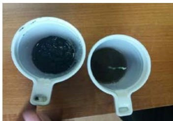
Рис. 4. Фото после диспергирования ВУС + бензин в верхней чашке
