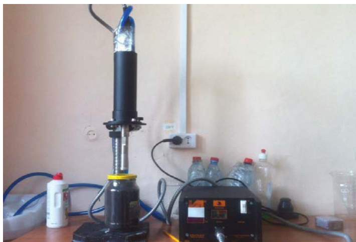
Рис. 3. Установка для диспергирования ВУС с бензином
