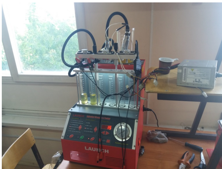
Рис. 5. Стенд для тестирования работы инжекторных форсунок.
