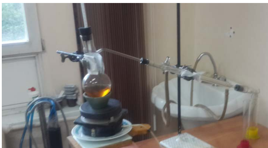
Рис. 2. Фотография установки для определения фракционного состава бензина (без защитного кожуха)
