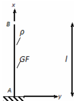
Рис. 1. Расчетная схема элемента с деформациями сдвига, с распределенной массой \rho
