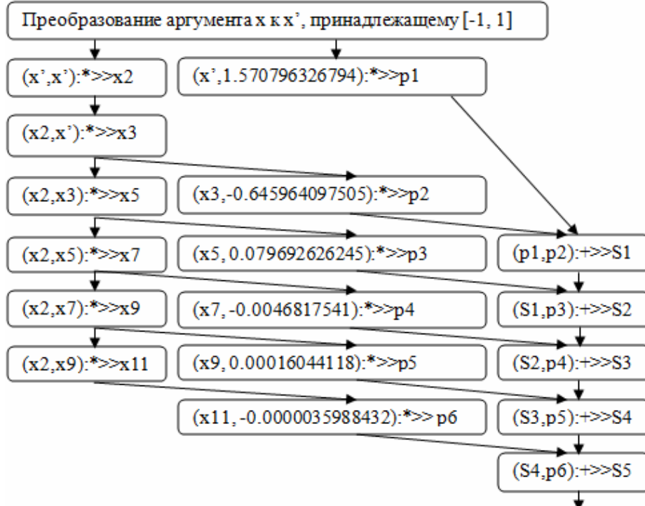
Рис. 1. Упрощенный информационно-управляющий граф функции \sin
