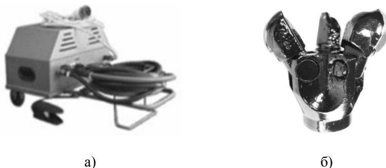
Рис. 1. Оборудование и инструмент, применяемые для обработки теплообменных труб: а – установка «Вулкан»; б – инерционно-режущий инструмент
