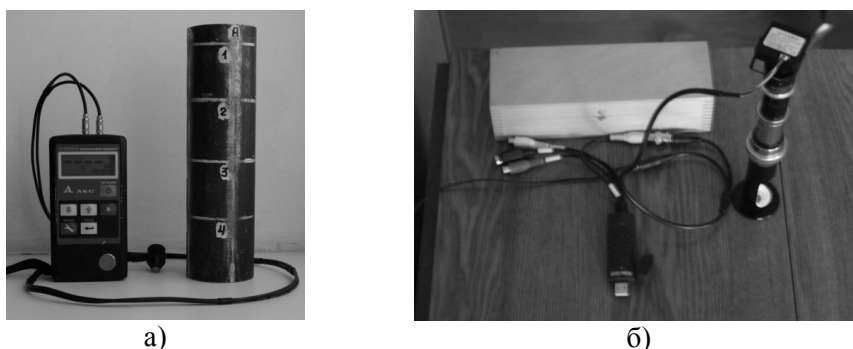
Рис. 3. Приборы, использованные для визуально-измерительного контроля: а — толщиномер ультразвуковой, б — микроскоп МПБ-2
