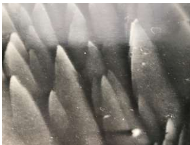
Рис. 3. Электронно-микроскопический снимок поверхности оксида цинка, подвергнутой распылению
