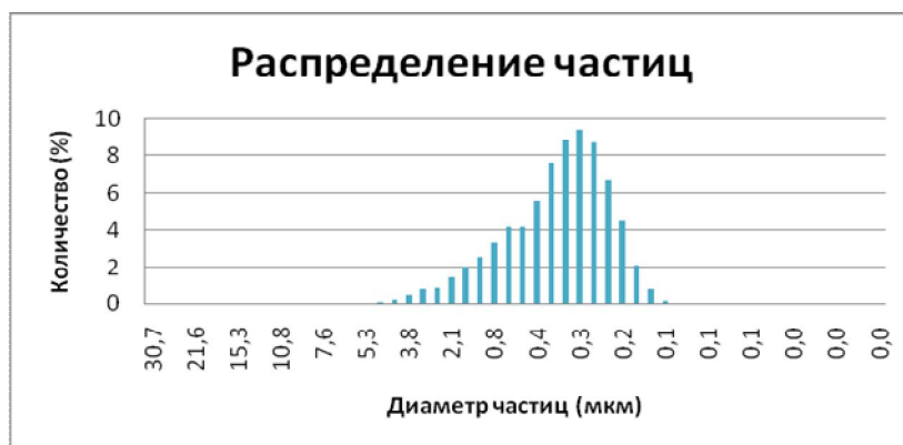
Рис. 2. Распределение наночастиц Ta-Si по размерам
