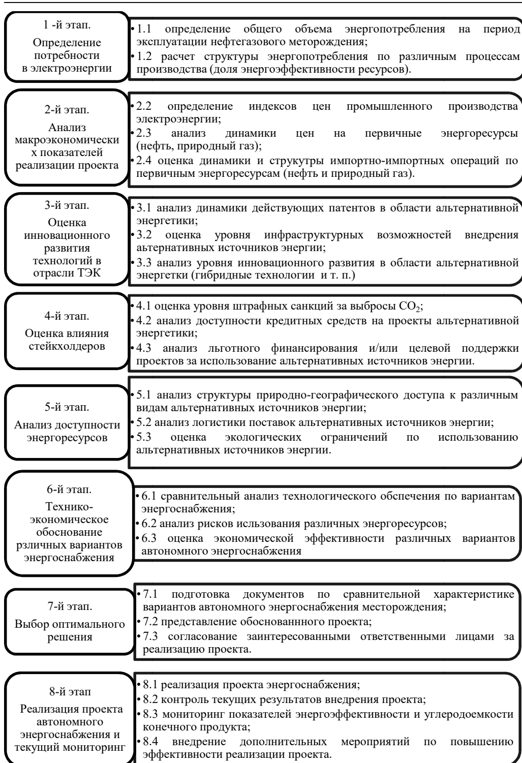
Рис. 1. Алгоритм выбора оптимального варианта системы автономного энергоснабжения нефтегазового месторождения
