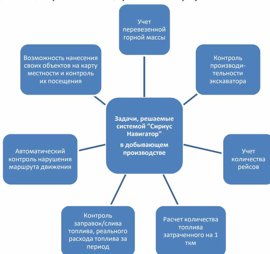
**Рис. 3.** Решение задач в добывающем производстве при использовании системы «Сириус Навигатор»
