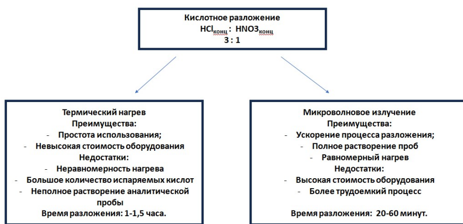
Рис. 1. Схема этапов пробоподготовки твердых образцов при количественном определении свинца и цинка в рудах полиметаллического месторождения
