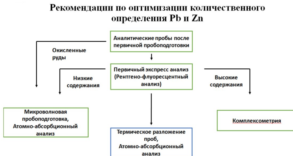
Рис. 7. Схема (рекомендации) оптимизации количественного определения Pb и Zn
