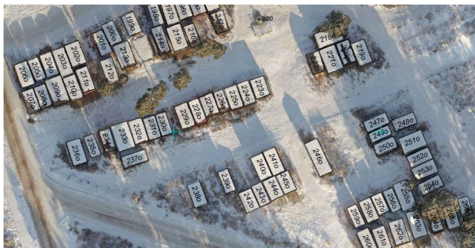
Рис. 3. Нанесение геодезических координат металлических гаражей на спутниковый снимок
