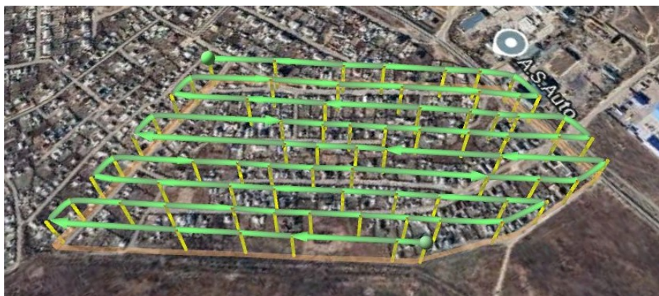
Рис. 2. Роботизированное полетное задание БПЛА
